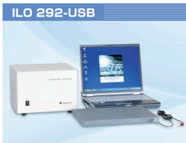
電源部（左）／本体（中央）／データ処理部（右） （ノート型パソコン）
